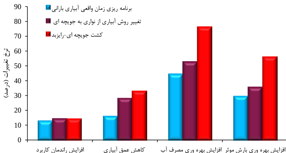
شکل ۳۶۳- مقادیر تغییرات پارامترهای آبیاری با به‌کارگیری تکنیک‌های مدیریت آبیاری در کشت پاییزه
