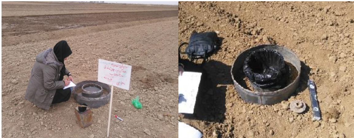
شکل ۴۰- اندازه‌گیری نفوذ به‌روش استوانه‌های مضاعف در مزارع مختلف
