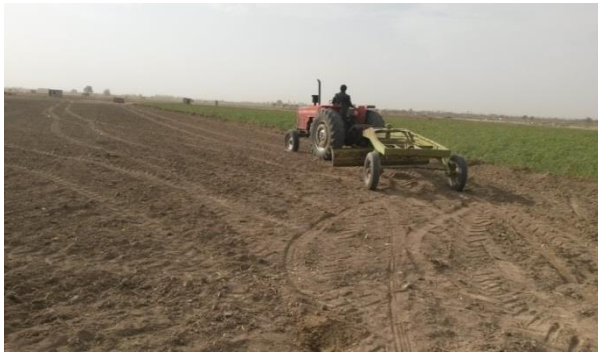
شکل ۳- استفاده از لولر جهت تسطیح زمین
