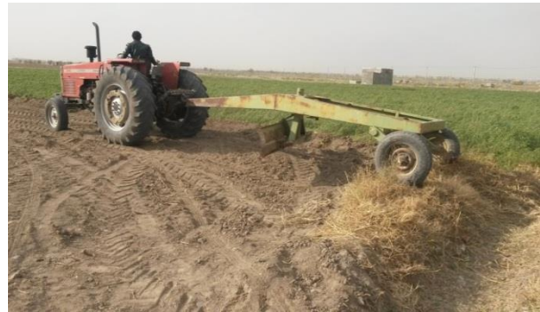
شکل ۳- استفاده از لولر جهت تسطیح زمین
